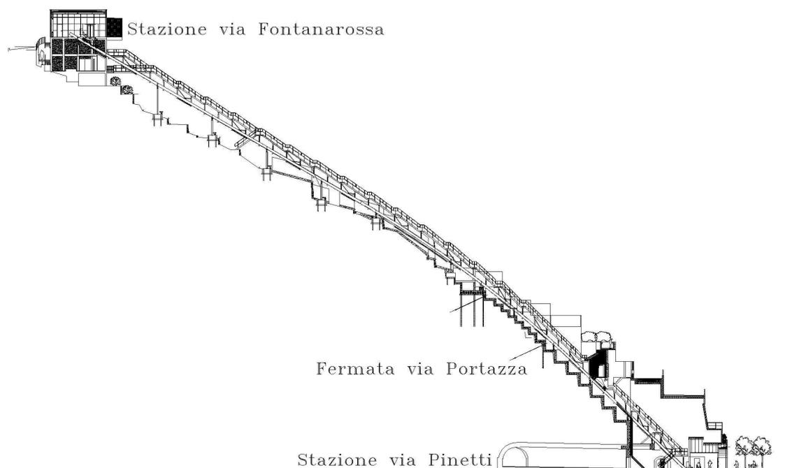
Profilo longitudinale del tracciato dell'ascensore inclinato "QUEZZI"
